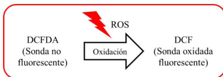
Figura 7. Esquema de reacción de la sonda DCFDA para la detección de las especies reactivas de oxígeno.
